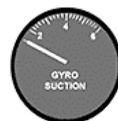
Fig.2.2.6 - Indicador de succión.
