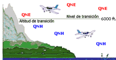
Fig.2.3.6 - Altitud y Nivel de transición.
