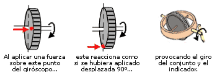
Fig.2.8.4 - Funcionamiento del indicador de viraje.
