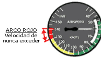
Fig.2.5.6 - Arco rojo anemómetro.
