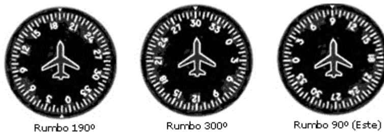
Fig.2.7.3 - Lectura del indicador de dirección.
