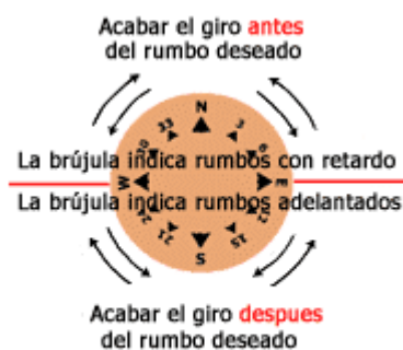
Fig.2.9.7 - Errores de viraje.
