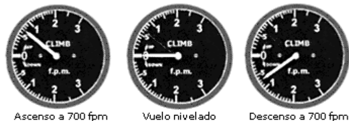
Fig.2.4.3 - Indicaciones del variómetro.
