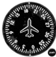
Fig.2.7.1 - Indicador de dirección.
