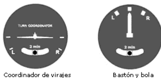
Fig.2.8.1 - Indicador de viraje y coordinación.
