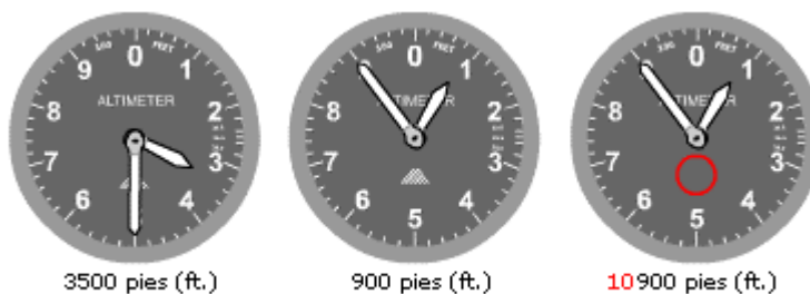
Fig.2.3.3 - Lectura del altímetro de dos agujas.
