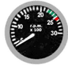
**Fig.3.3.2 - Tacómetro.**
