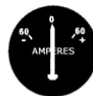
Fig.3.4.3 - Amperímetro.
