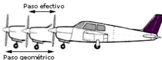
**Fig.3.2.6 - Paso efectivo y paso geométrico.**
