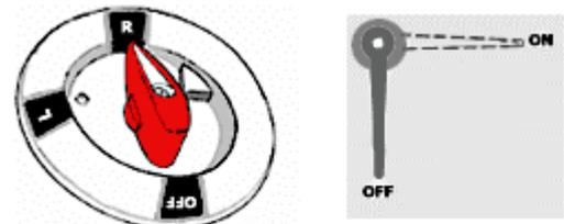
Fig.3.6.5 - Selectores de depósito.
