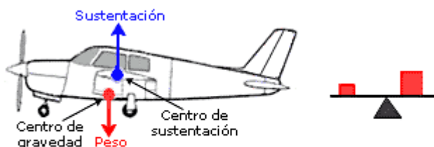
Fig.4.3.2 - Fuerzas ejercidas en un avión balanceado.
