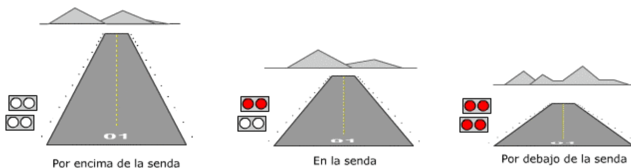
Fig.6.2.12 - Interpretación del VASI (Visual Approach Slope Indicator).
